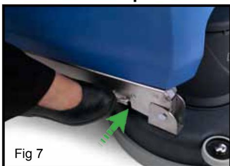
Pour amener le plateau en position abaissée (mode de fonctionnement), appuyez sur la barre de verrouillage du plateau de brosses (fig. 7) et faites pivoter le plateau (fig. 8).
