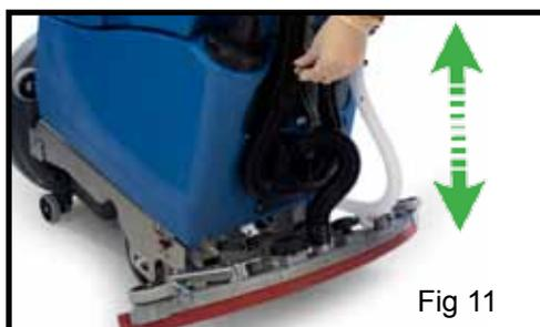
Relevez le suceur (déplacement) ou abaissez-le (nettoyage) au moyen de la poignée de levage située à l'arrière de la machine (fig. 11).
