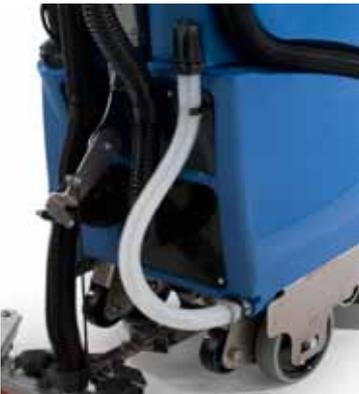
Le tuyau de vidange transparent situé à l'arrière de la machine peut être utilisé pour visualiser le niveau d'eau dans le réservoir d'eau propre.
