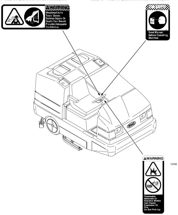
FLAMMABLE SPILLS LABEL - LOCATED ON THE SIDE OF THE OPERATOR COMPARTMENT.
